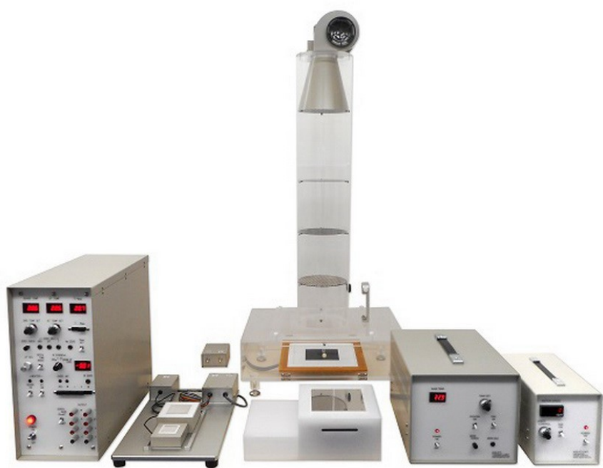
图 2-1 最大热流法测量原理和测试模型
