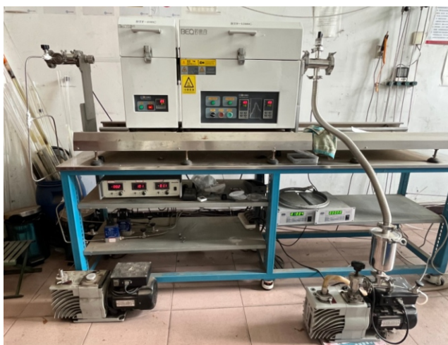
图1 需进行改造的真空石英管式炉及其真空控制系统
